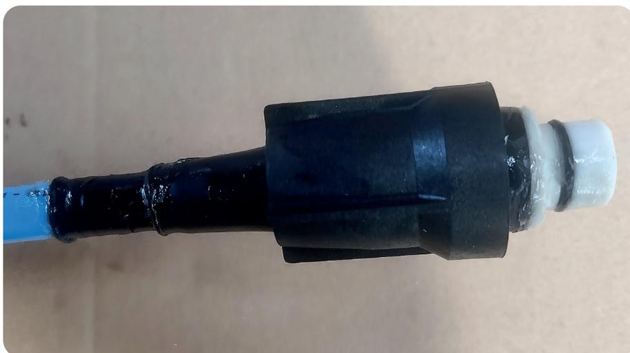
Pour finir, insérer l'écrou (2) par dessus la gaine extérieure et le faire tourner pour bien le graisser.
