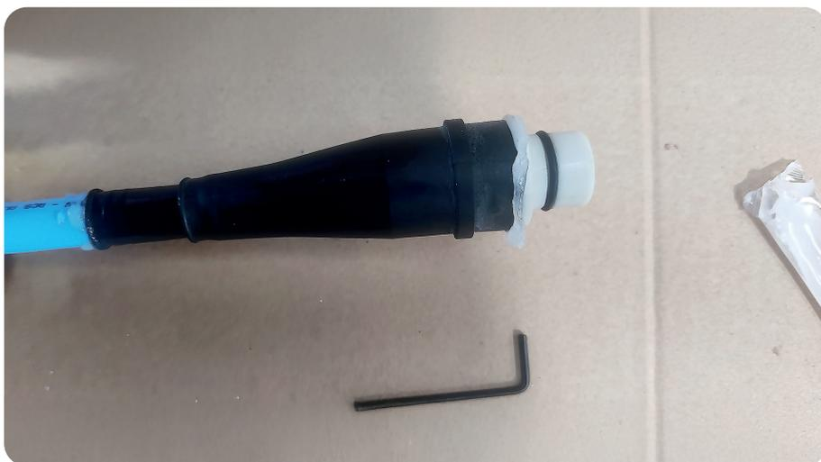
Enfiler la gaine extérieure (3) au dessus de la gaine intérieure (4) jusqu'à la seconde butée.
